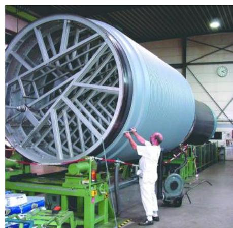
Si la virole est réalisée en « plaques cintrées », des plaques peuvent être soudées ensemble sur la machine à souder ou polyfusées entre elles. Après cette opération d'assemblage, la longueur de « plaque » correspond au développé de la virole. Celle-ci est cintrée et les 2 extrémités sont polyfusées entre elles.
