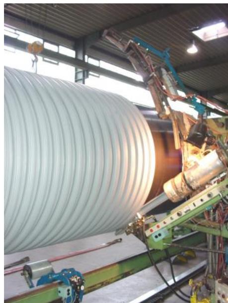
Si la virole est réalisée par extrusion enroulement, la matière plastique est extrudée à 240 °C sous la forme d'une bande continue autour d'un mandrin tournant préchauffé et sans discontinuité du début à la fin de la virole.
