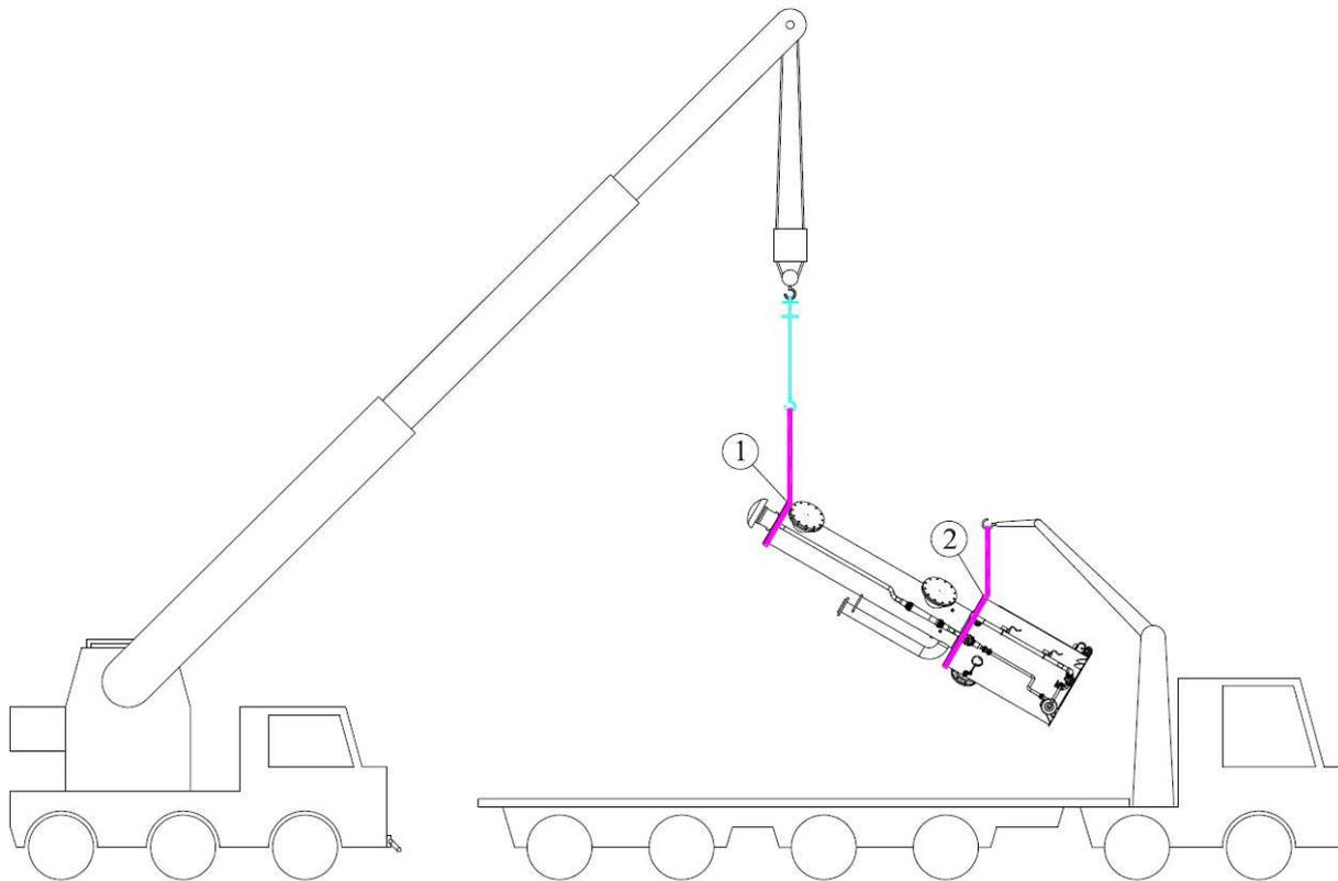
*Le laveur doit être déchargé et relevé à l'aide de 2 points de levage :*
