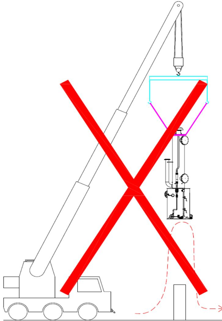
*Ne jamais lever le laveur au-delà de la hauteur nécessaire pour éviter les obstacles au sol.*
