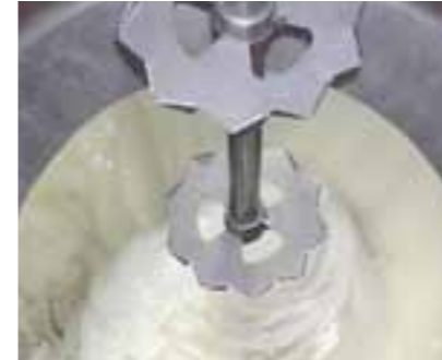
Agitateur Inox avec turbine spéciale "dispersion de poudre"
